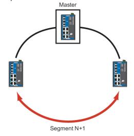
Если в кольце нечетное количество устройств EDS (2N+1 EDS), то резервный сегмент – это сегмент, соединяющий устройства EDS N+1 и EDS N+2.
