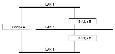
Если механизм STP активирован, он обнаружит параллельные пути и заблокирует один из них от передачи трафика. В примере показано, как STP определил, что трафик из LAN 2 в LAN1 должен проходить через мост С и А, поскольку у этого пути большая пропускная способность, а значит, он более эффективный.
