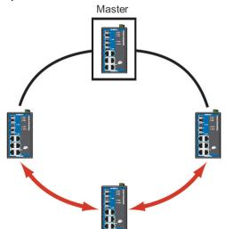
Если в кольце четное количество устройств EDS (2N EDS), то резервный сегмент – это один из двух сегментов, подсоединенный к устройству EDS N+1 (коммутатору, наиболее отдаленному от «мастера сети»).
