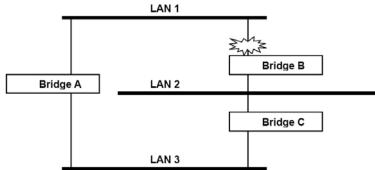
Что произойдет при сбое линии? Как показано на рисунке, механизм STP произведет автоматическое переконфигурирование сети, так чтобы трафик из LAN2 проходил через мост В.
