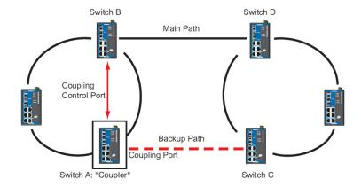
Для настройки Ring Coupling выберите два коммутатора EDS в одном кольце (например, коммутаторы A и B на приведенном рисунке) и два коммутатора в другом кольце (например, коммутаторы C и D).
