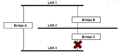
Протокол STP определит, какой путь между каждым сегментом является наиболее эффективным, и назначит корневой мост. После того, как были определены наиболее эффективные пути, другие пути будут заблокированы. На трех рисунках выше STP определелил, что путь через мост С наиболее эффективен, и заблокировал путь через мост В. После сбоя моста С STP пересмотрел ситуацию и открыл путь через мост В.
