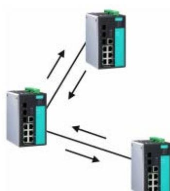
Благодаря этому, все устройства с функцией LLDP постоянно получают информацию о состоянии и конфигурации друг друга, а с функцией SNMP эта информация также может быть передана программному обеспечению Moxa для автоматического отображения топологии и настройки сети, **MXview**.
