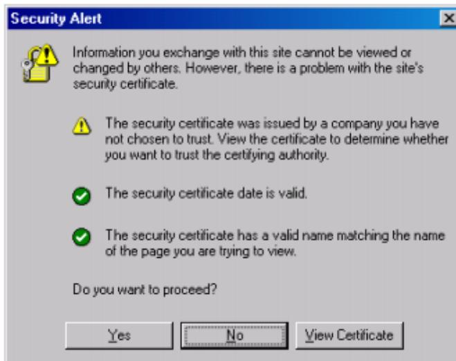
3. Нажмите **Yes** для входа в web-обозреватель коммутатора Moxa и получения доступа к интерфейсу, защищенному с помощью HTTPS/SSL.
