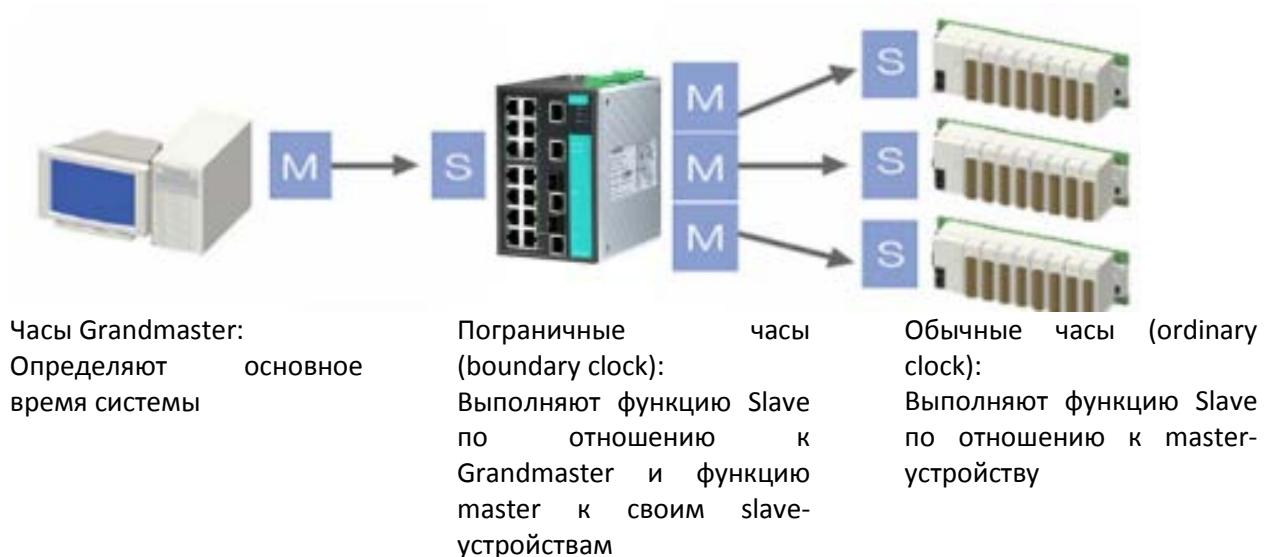
1. В коммутаторе должны быть реализованы функции пограничных часов (Boundary Clock) и прозрачных часов (Transparent Clock).
