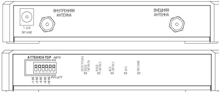
Переключателями № 1-5 АТТЕНЮАТОР устанавливается уровень ослабления входного и исходящего сигнала. Верхнее положение переключателей – выключено, нижнее положение – ослабление сигнала включено. Значения переключателей составляют -1; -2; -4; -8; -16 дБ, что соответствует ослаблению сигнала в 1,3; 1,6; 2,5; 6,3 и 40 раз. Одновременное включение нескольких переключателей приводит к суммированию соответствующих значений.
